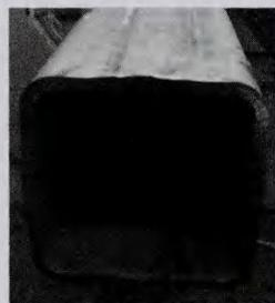
图 6 减壁量过小导致衬拉后方管四边平面度较差
